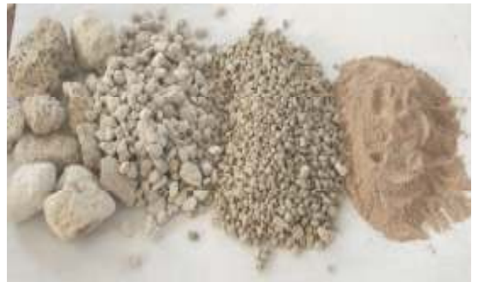
Şekil 10. Boyutlandırılmış pomza agregası örnekleri.
