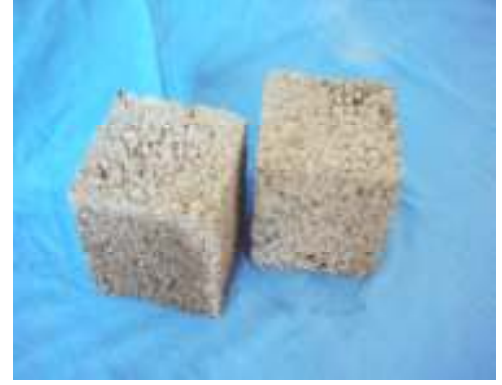
Şekil 12. Pomza agregalı kuru karışım beton örnekleri genel görünümü.
