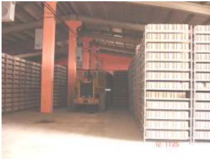
Şekil 15. Blok elemanların doğal ortam koşullarında kürlenmesi (KALEBLOKBİMS).
