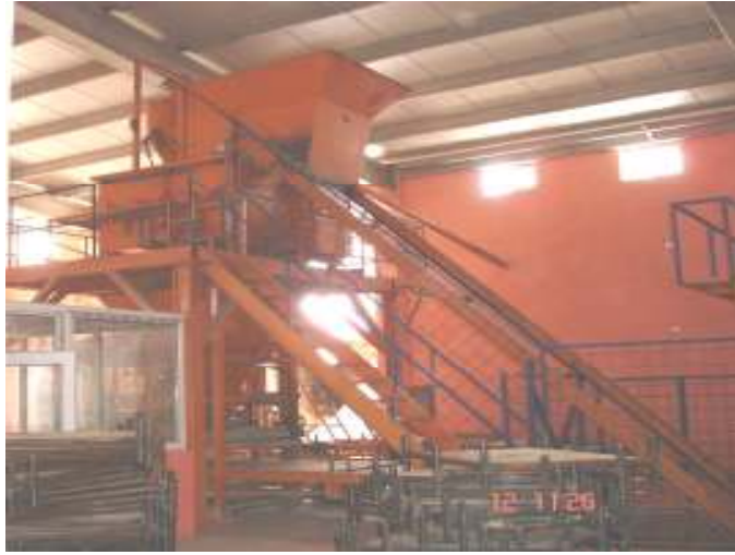
Şekil 14. Blok elemanların yarı otomasyon ünitesinde üretimi (KALEBLOKBİMS).
