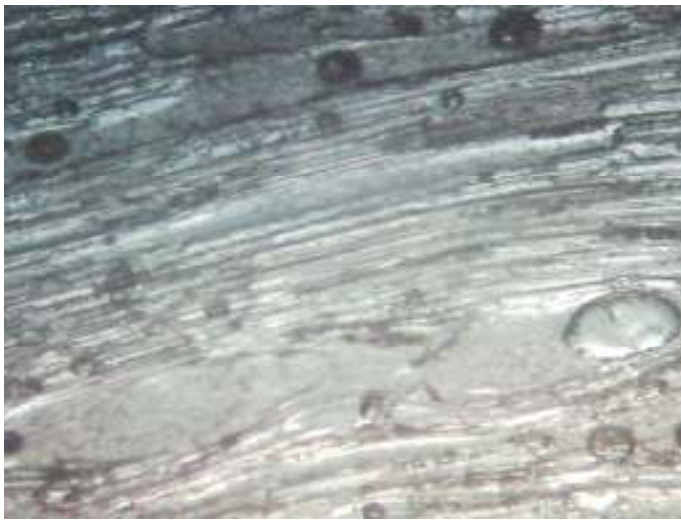
Şekil 9. Kayaçtaki kama yapısı ve opak mineraller.
