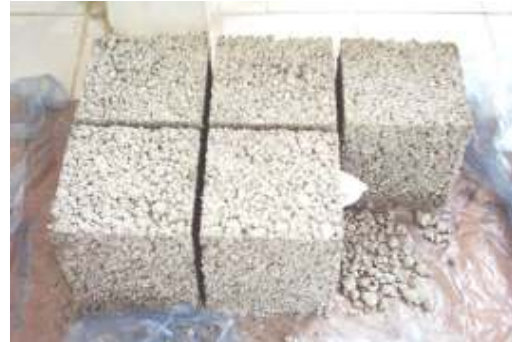
Şekil 1. Genleşmiş perlit agregalı katkı bimsbeton örnekleri genel görünümü. (160 kg/m 3 çimento dozajı).
