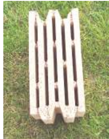
Şekil 4. Analizlerde kullanılan boşluklu ve lamba zıvanalı blok elemanı formu.
