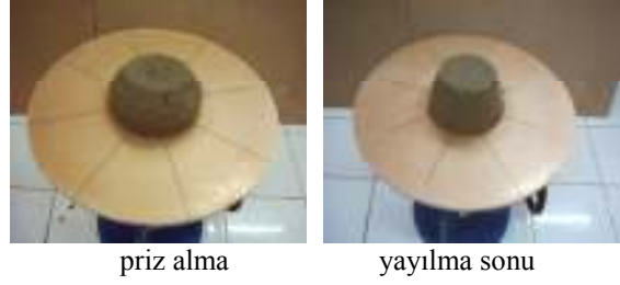
Şekil 8. Akma tablası yöntemine göre sıva harcının yayılma değerlerinin ölçümü.
